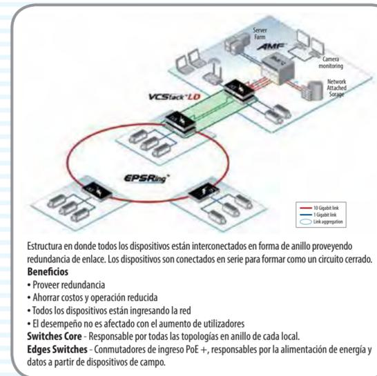
Estructura en donde todos los dispositivos están interconectados en forma de anillo proveyendo redundancia de enlace. Los dispositivos son conectados en serie para formar como un circuito cerrado.
